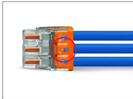
Leiteranschlag am Gehäuse und korrekte Abisolierlänge im farbigen Deckelsichtfenster visuell prüfen.
