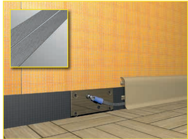
Abb. 4: Erdungsplatte unter Sockelleiste / Führung des Erdungsbandes bis zum Unterverteiler
