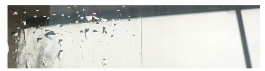
Links: Die Folie wurde per Hand und trocken auf die Scheibe geklebt -> Luftblasen. Rechts: Die Folie wurde naßverklebt mit Montagekonzentrat FMK30 und Rakel FVR10 -> Keine Luftblasen.
