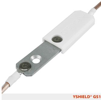
Kleine und flache Erdungsplatte 20x80 mm zur Montage direkt auf Abschirmprodukten und auf Erdungsbändern. Für den Sockelleistenbereich. **Montage aufgrund der kleinen Erdungsfläche bevorzugt im Sockelleistenbereich mit Abschirmfarbe, Abschirmgewebe. Verwendung nur im Innenbereich. Aufgrund der kleinen Auflagefläche wird pro Wand ein Stück benötigt. Höhe fertig montiert nur 4 mm (ohne Deckel) oder 6 mm (inklusive Deckel).**
